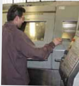
Ufip-Mitarbeiter Calogero (l.) entfernt Gussgrate und stanzt das Mittelloch. Kollege Emanuele (r.) bringt die Roh-Becken durch maschinelles Abdrehen auf ihr Zielgewicht.
