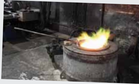
Bei Temperaturen von über 1000 Grad verschmelzen die Metalle zur B20-Legierung (20 % Zinn, 80 % Kupfer) der Serien Class, Class Brilliant, Bionic, Extatic, Experience, Rough und Natural.
