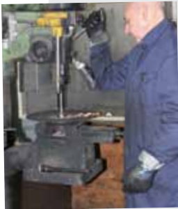
Ufip-Mitarbeiter Calogero (l.) entfernt Gussgrate und stanzt das Mittelloch. Kollege Emanuele (r.) bringt die Roh-Becken durch maschinelles Abdrehen auf ihr Zielgewicht.
