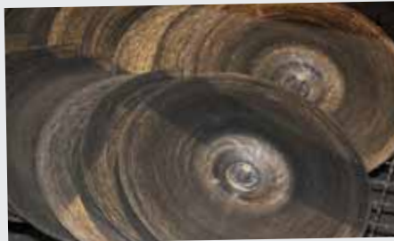
Rohlinge: Durch das besondere Gussverfahren sind Ufip-Becken an der Glocke dicker als andere Becken, da das Metall nicht durch Hämmern oder Stanzen gedehnt wird.
