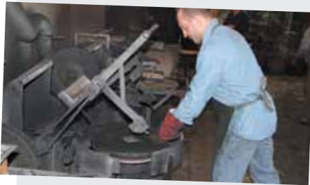
Die Bronze erhärtet noch in der Form. Alberto Biasei: „Im Unterschied zu anderen Herstellern gießen wir mit Glocke. Die Zentrifugalkraft schleudert Unreinheiten oder Blasen aus den Becken heraus.“
