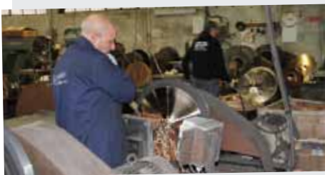
Der letzte Feinschliff, ein weiterer Abdrehvorgang, erfolgt per Hand – hier durch Mitarbeiter Galogero. Dies bestimmt, zusammen mit dem Hämmern, den Beckenklang.
