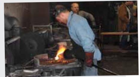
Nur Ufip fertigt) im patentierten Rotocast-Verfahren (hier Mitarbeiter Massimo: „Die Gussformen rotieren mit 1000 Umdrehungen/Min., wenn wir die flüssige Bronze hineingießen“, erläutert Chef Alberto Biasei.
